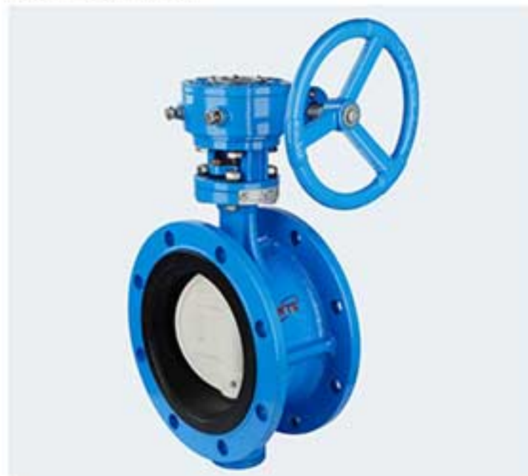
软密封蜗轮法兰衬胶蝶阀 D341J-6/10/16
